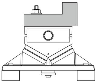
图示：带有下轨道的 MD+UMS-ASF, 用螺栓固定
